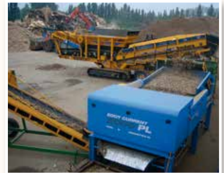
Separator wirowo-prądowy o szerokości 2000 mm do przetwarzania odpadów drzewnych
