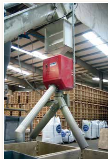
Detektor metali w transporcie grawitacyjnym (recykling)
