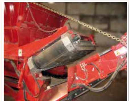
Podwieszany separator NEOFLUX® na maszynie do rozdrabniania drewna (lekki i mały)
