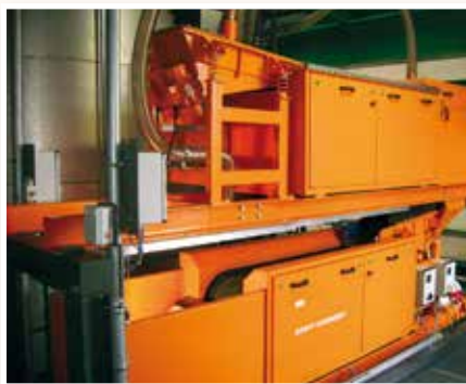
Kaskadowy separator metali nieżelaznych do usuwania do 2 do 10 milimetrowych cząsteczek metali z żużla
